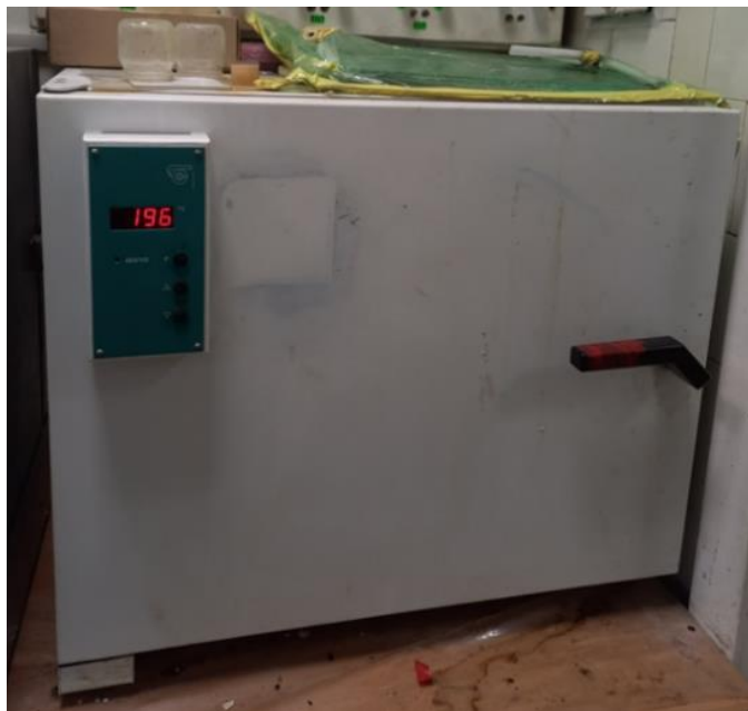
Рисунок 7 – Шкаф сушильный ШС-80-01 СПУ
