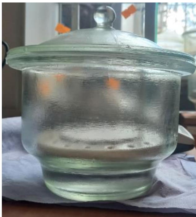
Рисунок 9 – Стекланный эксикатор. Внутри помещен образец из ППВФ и аминокaproновая кислота
