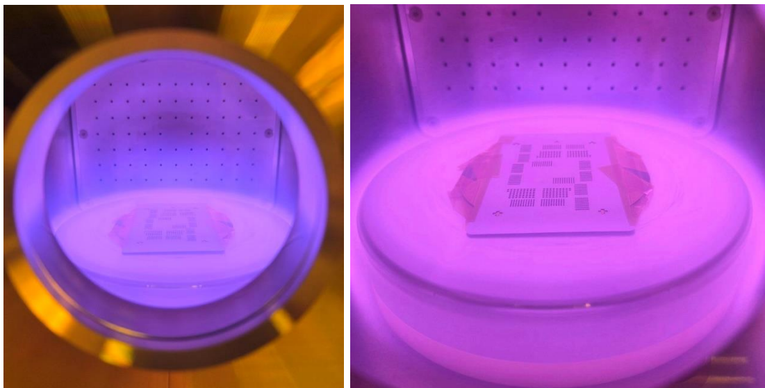
Рисунок 30. Процесс открытия контактных площадок с помощью маски методом реактивного ионного травления
