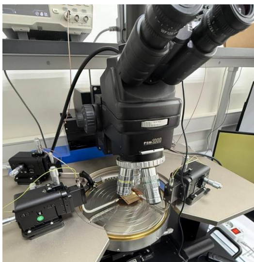
Рисунок 35. Процесс электрического тестирования мультиэлектрода на зондовой станции SemiShare E8.
