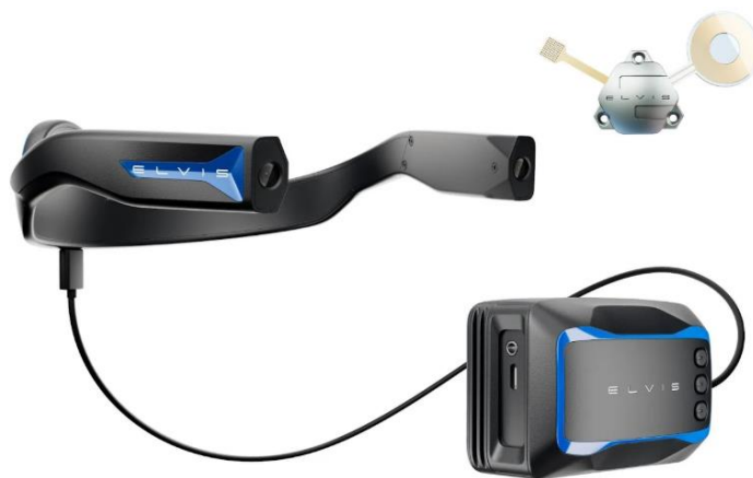
Рисунок 10. Система ELVIS V, состоящая из головного блока, поясного блока и мультиконтактного электрода.
