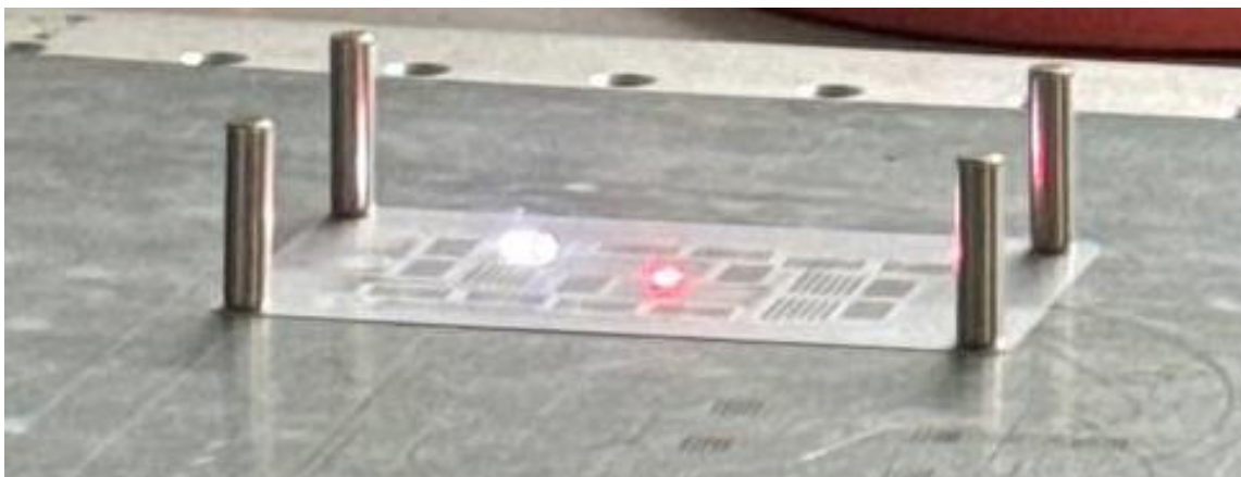
Рисунок 29. Процесс изготовления маски для травления методом лазерной вырезки
