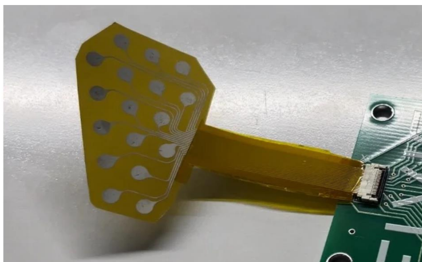
Рисунок 11. Гибкая полиимидная подложка с 17 платиновыми контактами (ранний образец).
