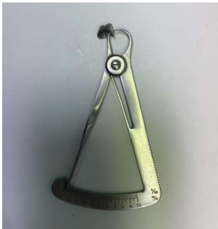
Рис. 14 Проверка толщины каркаса.
