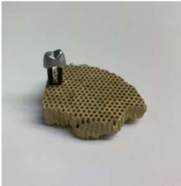
Рис. 15 Готовый каркас металлокерамической коронки.
