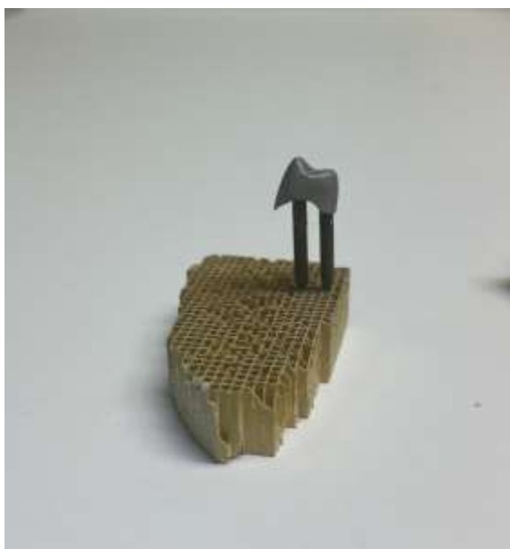
Рис. 16 Металлический колпачок после пескоструйной обработки.
