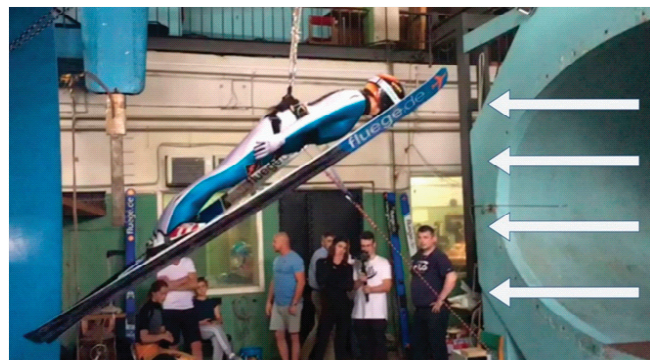
Рис. 1. Направление воздушного протока в горизонтальной аэродинамической трубе
