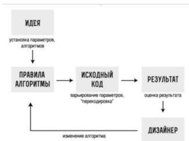
Рис. 1 Схема процесса работы в направлении генеративного дизайна
