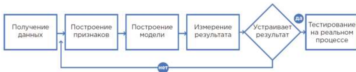
Рис. 8 Принцип работы алгоритма ИИ
