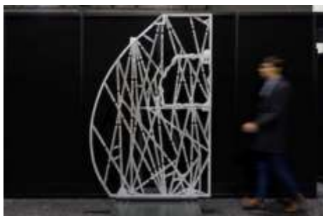
Рис. 2 Облегченная перегородка для интерьера салона
