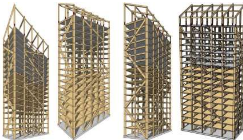
Рис. 7 Конструктивная схема здания
